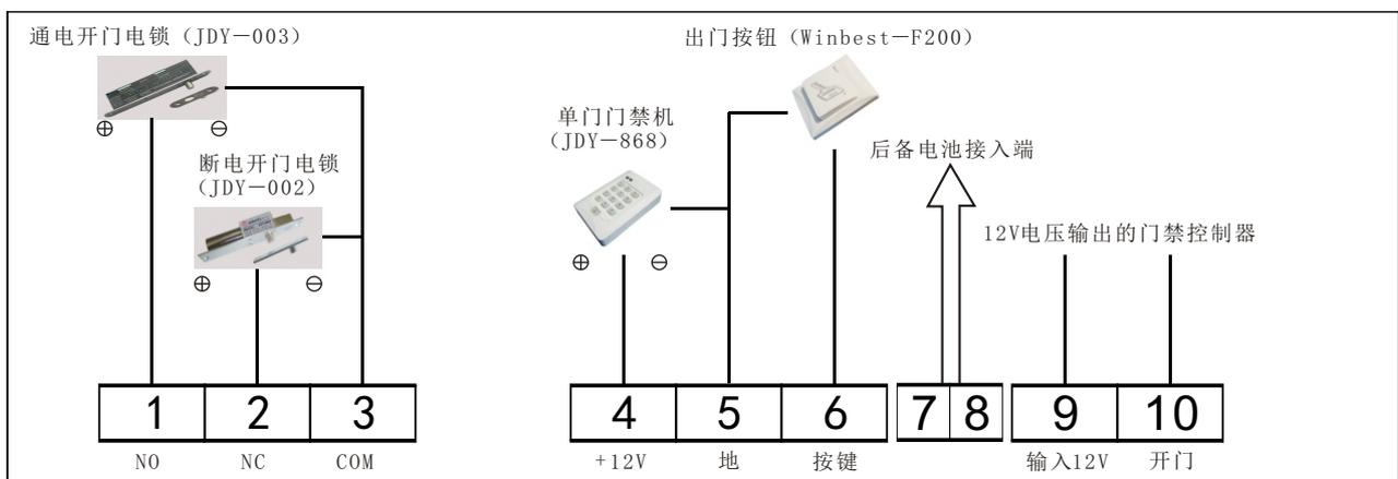
1—3: NO端与COM端，常态无输出，按键触发后输出DC12V (0-10秒)，1为正，3为负      2—3: NC端与COM端，常态输出DC12V，按键触发后断电 (0-10秒)，2为正，3为负      4—5: DC12V输出，4为正，5为负      6—5: 开门按钮输入端，可接开关信号输出 (继电器输出) 控制电锁的门禁控制器      7—8 后备电池接入端，7为正，8为负      9—10: 输出12V电压开门，专用于直接输出电压控制电锁的门禁控制器
